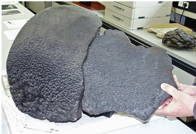
Abbildung 4.6: Ein Stück der Mangankruste 237KD vom Zentralpazifik aus einer Tiefe von ca. 4830 m.
