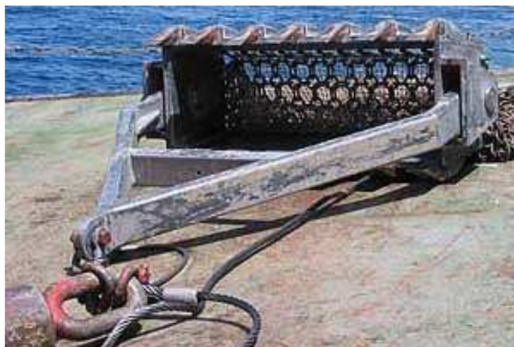
Abbildung 4.2: Eine Kettensack-Dredge für die Gewinnung der Proben (Quelle: http://www.bgr.de ).
